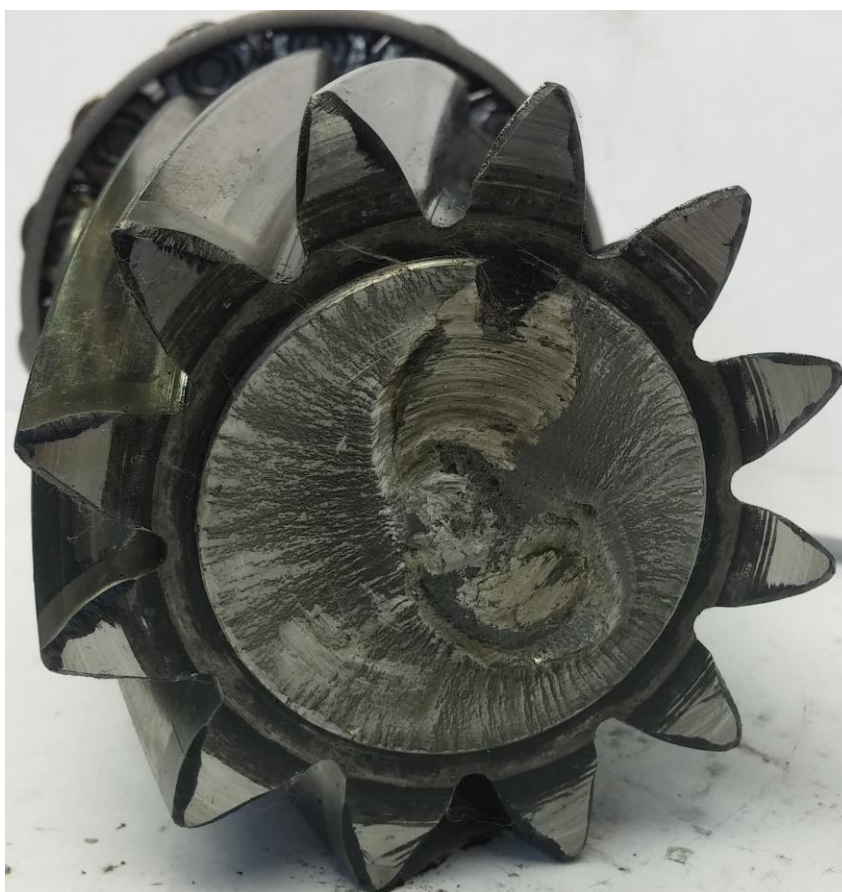
Рисунок А.10 – Внешний вид вала-шестерни редуктора с ЭЦ зубчатым зацеплением после испытаний
