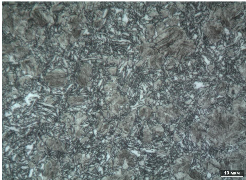
Рисунок 4.2 – Микроструктура сердцевины зуба детали, х 1000.
