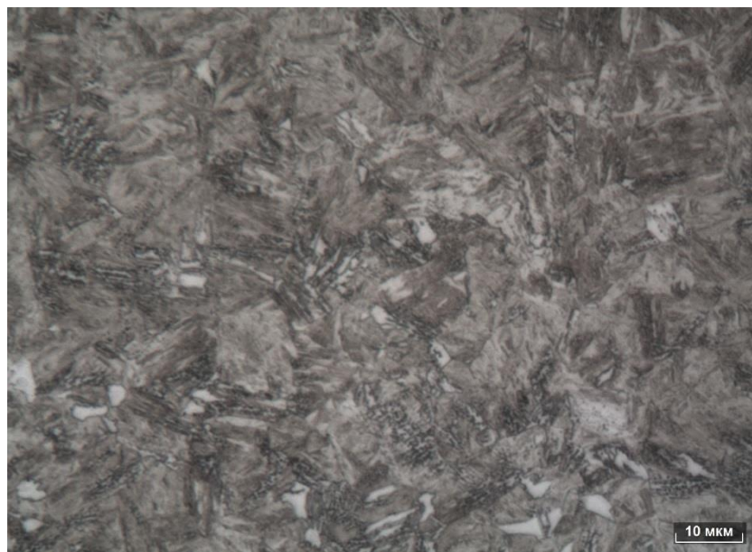
Рисунок 4.2 – Микроструктура сердцевины зуба детали, х 1000.
