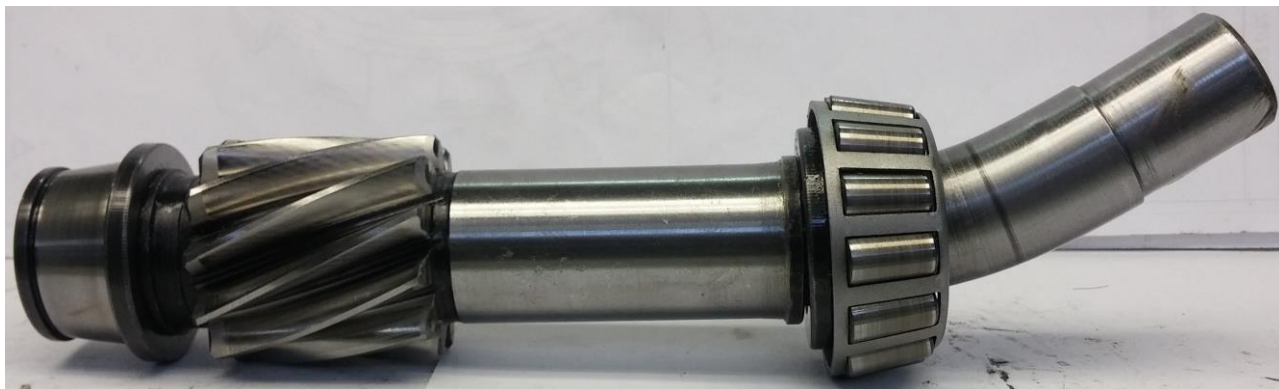
Рисунок А.9 – Внешний вид входного вала-шестерни редуктора с ЭЦ зубчатым зацеплением после испытаний
