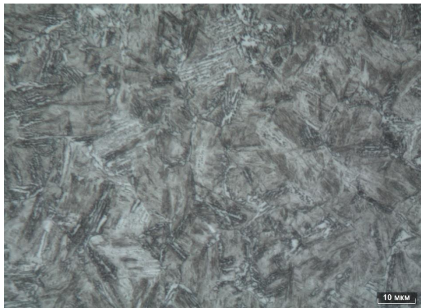
Рисунок 4.2 – Микроструктура сердцевины зуба детали, х 1000.
